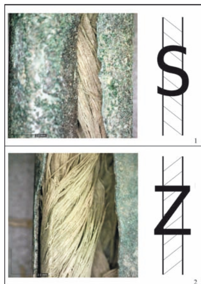
Fig. 2. Direction of a twist: 1 – left (S); 2 – right (Z) (photo: M. Przymorska-Sztuczka)
